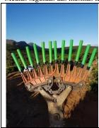
**Figura 1.** Detalhe dos extensores de borracha. Deve-se usar o tubo de borracha preto de látex para maior durabilidade. Deve ser preso engrossando os dedos com fitas isolantes e passando cola de PVC para aderência.
