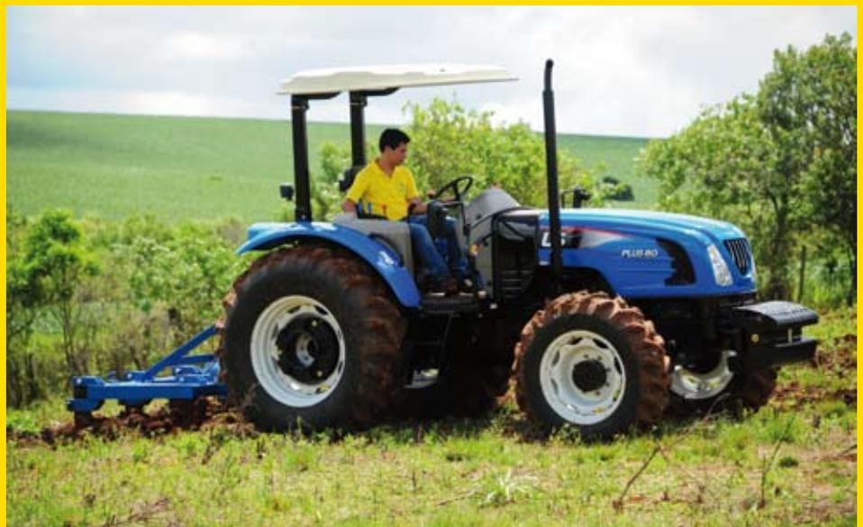
Para o teste de campo, utilizamos um escarificador superdimensionado para este trator, com sete hastes parabólicas, marca São José, modelo AS 190X7CP
