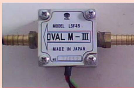
**Sensor de fluxo volumétrico de combustível para determinação do volume de gasto na operação**
