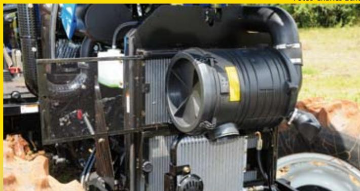
Detalhe das duas grades de radiadores responsáveis pelo arrefecimento do motor e sistema hidráulico
