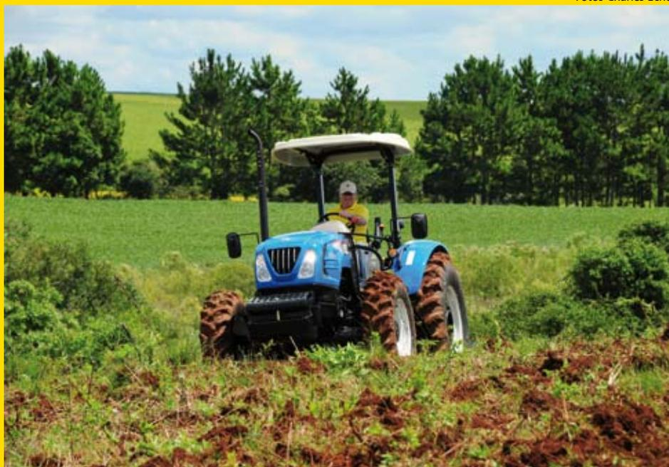
isso, em operações com implementos que requerem 540rpm e 1.000rpm, baixa potência na TDP, funciona como a maioria dos tratores brasileiros. No entanto, para a rotação de 750rpm que é pouco difundida, a LS está orientando aos produtores utilizar esta opção como uma rotação de 540rpm econômica, pois se obtém a mesma rotação de TDP com uma menor rotação do motor, obtendo-se como benefício um menor consumo de combustível.
