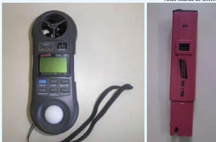
Termo-higrômetro-anemômetro-luxímetro e pHmetro utilizados para determinação das condições de aplicação
