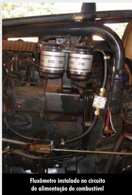
Fluxômetro instalado no circuito de alimentação de combustível
