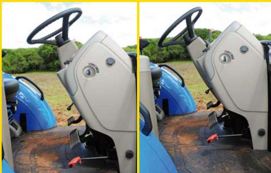
A plataforma possui um tapete antiderrapante espesso e a coluna de direção possui sistema de ajuste longitudinal e de altura que, em conjunto com o banco completamente regulável, possibilita bastante conforto ao operador
