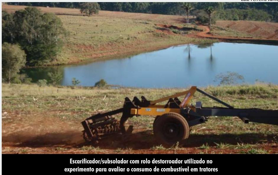
Escarificador/subsolador com rolo destorroador utilizado no experimento para avaliar o consumo de combustível em tratores
