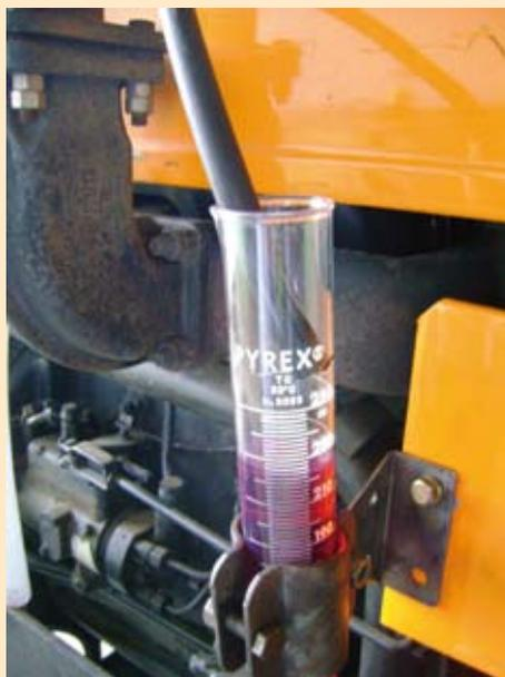
Reservatório de combustível instalado no trator com proveta graduada
