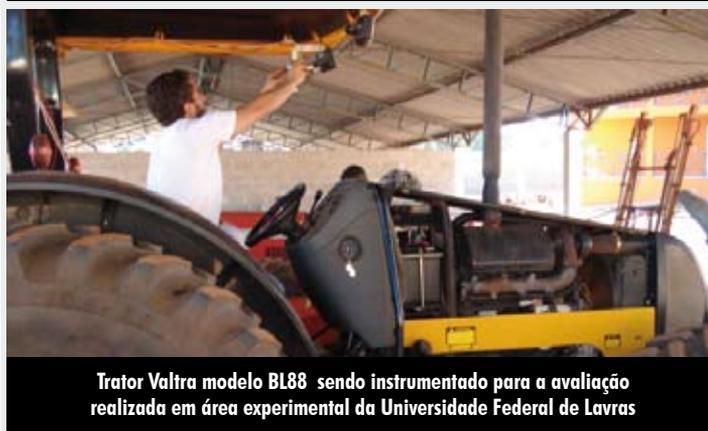
cífico de combustível por unidade de área, utilizou-se a equação 2 (Box). O consumo horário de combustível foi medido por meio de um fluxômetro eletromecânico. É possível observar no gráfico de consumo horário de combustível, que independentemente da profundidade de escarificação (10cm ou 20cm), o consumo foi proporcional ao aumento da velocidade operacional.
