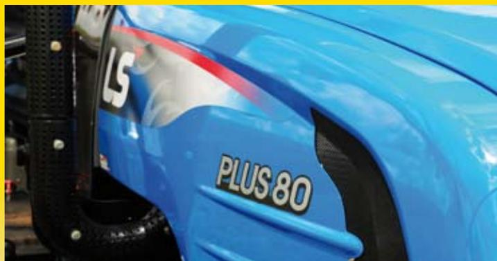
O LS Plus 80 vem com novas entradas de ar posicionadas na parte frontal do capô e proteção no cano de escapeamento de gases do motor
