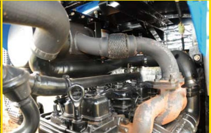
O motor de 75cv é MWM, modelo Maxforce 229-4 de aspiração natural. Possui quatro cilindros verticais com um volume deslocado de 3,9 litros. O cárter do motor fica localizado no lado direito do motor em um reservatório especialmente construído para proporcionar que a árvore de acionamento do diferencial dianteiro passe pela parte central do trator
