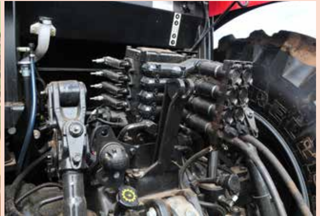
As válvulas de controle remoto sempre são compostas por um par de acopladores com engate rápido que fazem a saída e o retorno do óleo para os atuadores
