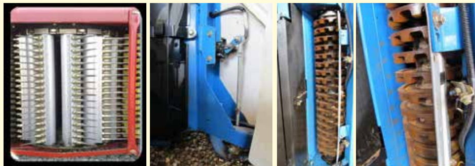
Ajuste do controle de altura da unidade (esquerda) e sensor de monitoramento da porta
