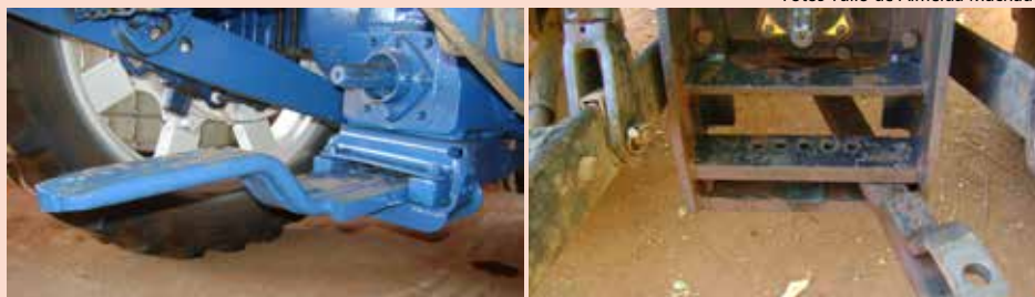
À esquerda, barra de tração do tipo degrau (fixa) e à direita, barra de tração do tipo boca de lobo (oscilante)
