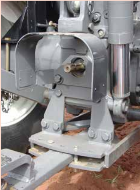
Tomada de potência (TDP) de 6 frisos, correspondente a 540rpm
