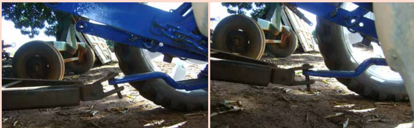
A posição do engate do implemento e o local onde a força de reação é aplicada influenciam diretamente a força de tração aplicada
