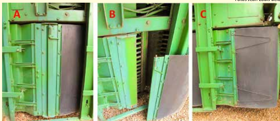
Placas de raspagem no tambor: dianteira (a), desmontada (b) e montada no tambor traseiro (c)
