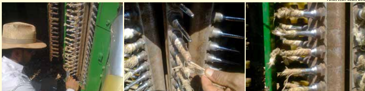
Detalhes do sistema de limpeza dos fusos (esquerda), fiapos nos desfibradores (centro) e encarneiramento das plumas nos fusos (direita)
