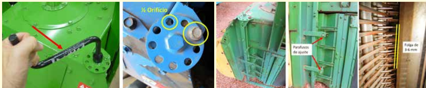
Regulagem das placas de pressão para ajustar de acordo com o adensamento de cada lavoura
