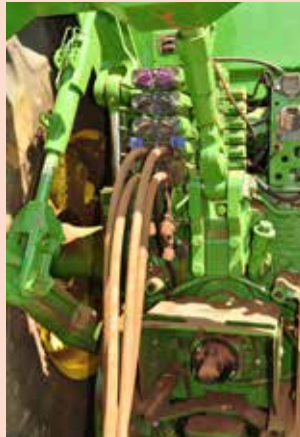
As válvulas de controle remoto sempre são compostas por um par de acopladores com engate rápido que fazem a saída e o retorno do óleo para os atuadores
