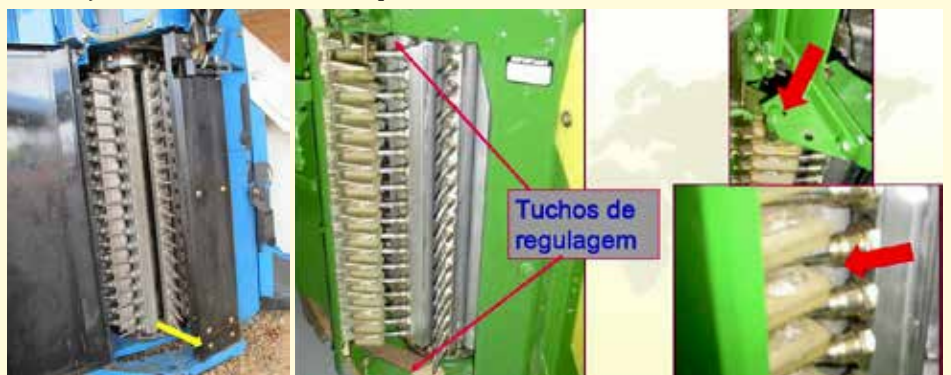
Ajuste da guia da coluna umidificadora e da posição da coluna umidificadora
