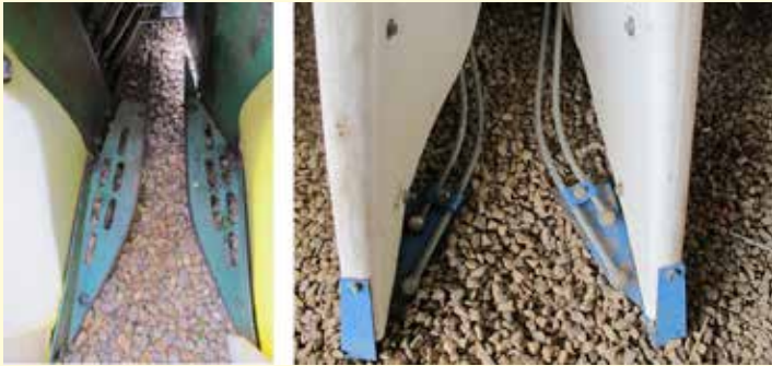
As guias de plantas precisam estar reguladas a uma altura de 25mm da superfície do solo
